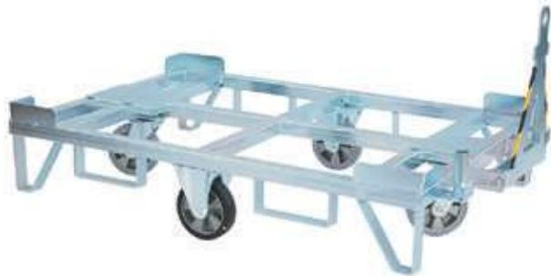
Carro 1200x800 para el transporte de material compatible con 4 cajas estándar Eurobox, palet europeo, base configuración diamante, y con lanza enganche apto para realizar un tren (milk-run).
