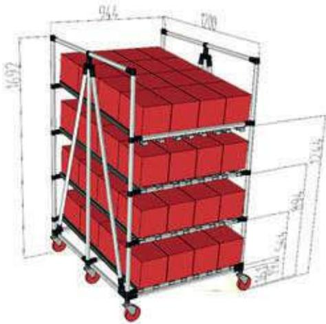
Estantería dinámica ideal para mantener el suministro de material con un sistema FIFO, tanto para puestos de trabajo como pequeños supermercados de abastecimiento, ligeras, tremendamente versátiles, estables tanto con patas como con ruedas con freno, y con la posibilidad de realizarse en doble sentido para permitir el intercambio de material mediante cajas en los puestos de trabajo: por un lado en sentido de entrada de materias primas y salida de producto terminado.
