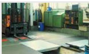
Las tapas de fosos de aluminio se utilizan para proteger fosos abiertos en salas de trabajo y talleres y permitir un acceso y conducción seguros.
