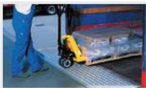
El riel de carga transitable de aluminio crea una conexión entre la rampa y el vehículo. La zona de carga trasera transitable con plataforma de chapa estriada es una pared lateral y un puente transitable en un solo elemento.
