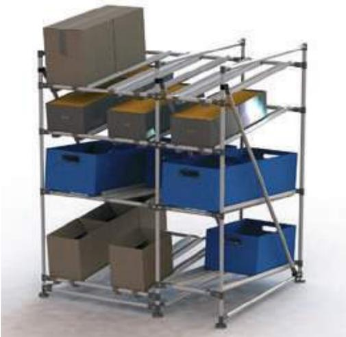
Dimensiones: 1000x900x1600 en la parte más alta. Tubo 28x2 mm con uniones de acero pintadas con cataforesis. Estructura para almacenaje con 4 anales de retorno, la parte inferior es para producto terminado. Minicarril camino de rodillo. Guías de PVC.
