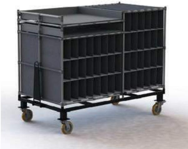
Dimensiones 1800x900x1600. Tubo 28x2. Diseñado para piezas pequeñas, una pieza por cada casillero. Bandejas madera fina forrado en tela. Paredes de tela tensada. Superficie FOAM. Superficie de tubo cuadrado 40x40. Ruedas con freno diámetro de 100 vulcanizadas.
