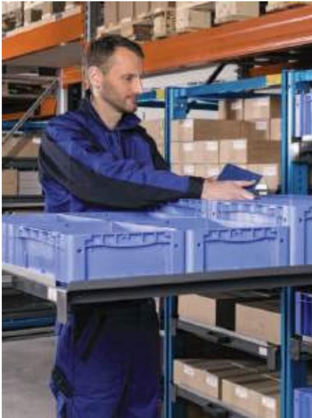
Estantería de Almacenamiento Ergonómico equipada con 3 a 7 niveles de almacenamiento según se elija, con capacidad para 200kg cada uno. La capacidad de extracción es de 70% o 100% según necesidades, pudiendo ser fabricada para extracción bidireccional. Asegurada con cierres en los límites para que la carga no se desplace. Ideal para picking de piezas sueltas.
