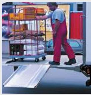
Estos carriles de carga se utilizan para puentear aceras y para carga y descarga lateral en plataformas elevadoras hidráulicas. Son una valiosa ayuda en el manejo eficiente de mercancías.
